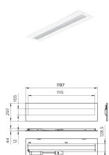
**Caractéristiques Philips Dalle LED CoreLine RC136B 22/31W 3100-4300lm - 840 Blanc Froid | 120x30cm - UGR <19 - Dali Dimmable - Puissance Réglable**
