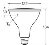
**Caractéristiques Ledvance Performance Spot LED E27 PAR38 13.5W 1035lm 15D - 827 | Remplacement 120W**
