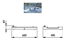
Technische Daten Philips LED-Highbay GentleSpace BY481P CLO 162W 25000lm 44D - 840 | IP65 - Dali Dimmbar
