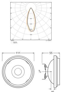
**Technische Daten Ledvance LED-Spot G53 AR111 11.7W 800lm 40D - 930 | Höchste Farbwiedergabe - Dimmbar - Ersatz für 75W**
